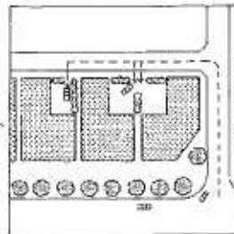
右：駐車場を裏側の配置とし、出入口以外を植栽で遮蔽する事例
